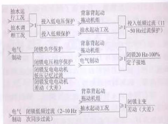
图 3 保护投入或闭锁逻辑图
