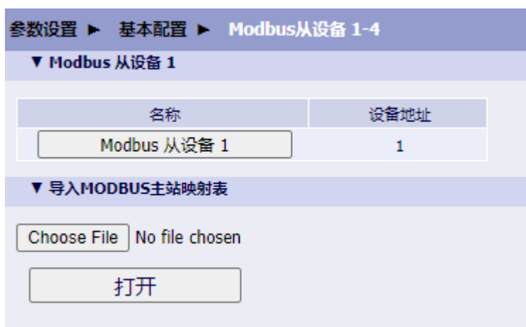
图 3-30 导入 Modbus 主站映射表
