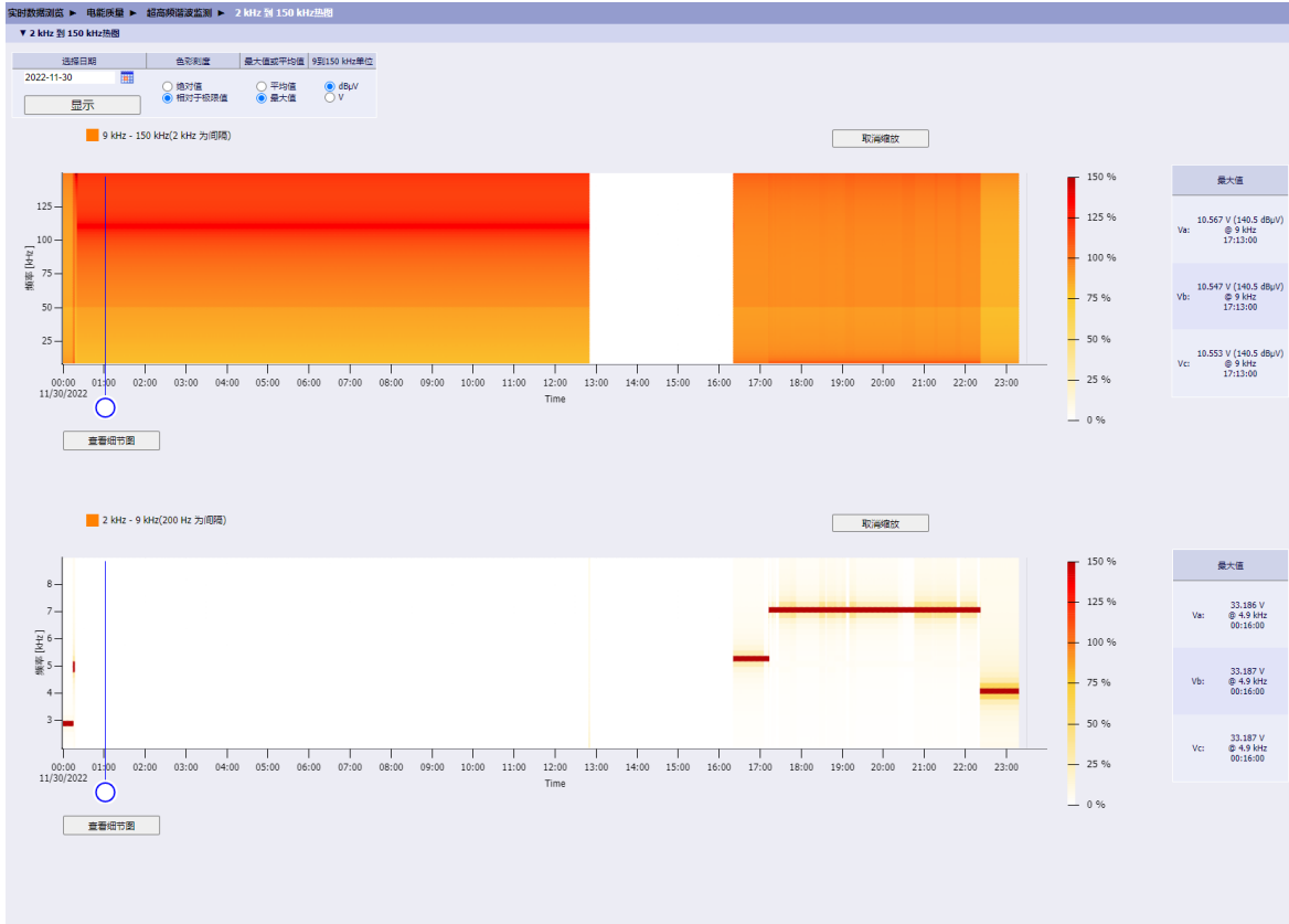
图 5-9 2 kHz 到 9 kHz 和 9 kHz 到 150 kHz 谐波的单日记录：相对于极限值（谐波发射限值）
