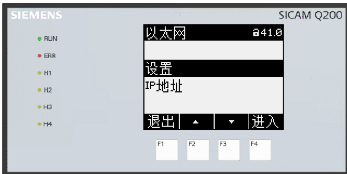
图 3-52 显示屏以太网通信界面
