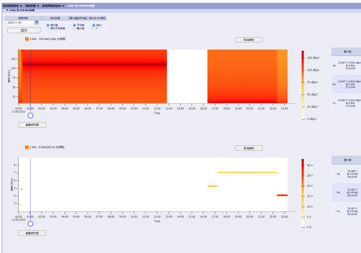
图 5-8 2 kHz 到 9 kHz 和 9 kHz 到 150 kHz 谐波的单日记录：平均值
