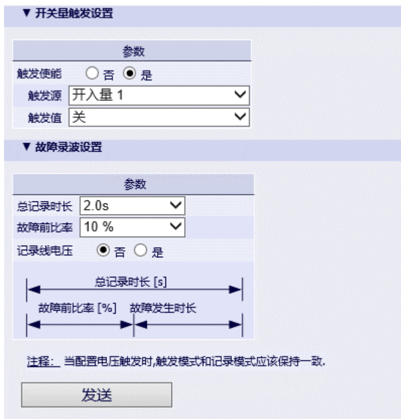
图 5-3 开关量触发-开入量
