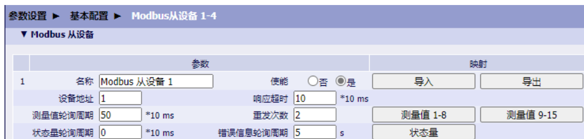
图 3-18 Modbus 从设备配置界面，设备 1 已激活
