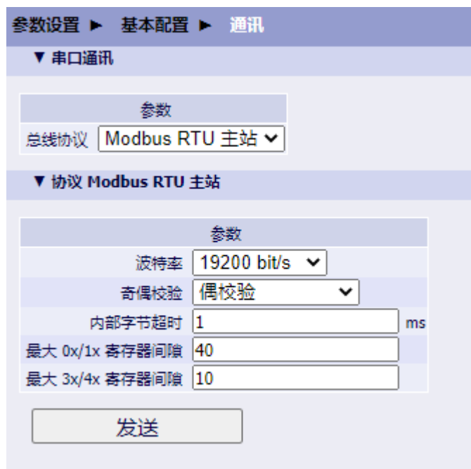
图 3-16 配置 Modbus RTU 主站
