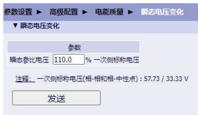
图 4-17 配置瞬态电压变化参数
