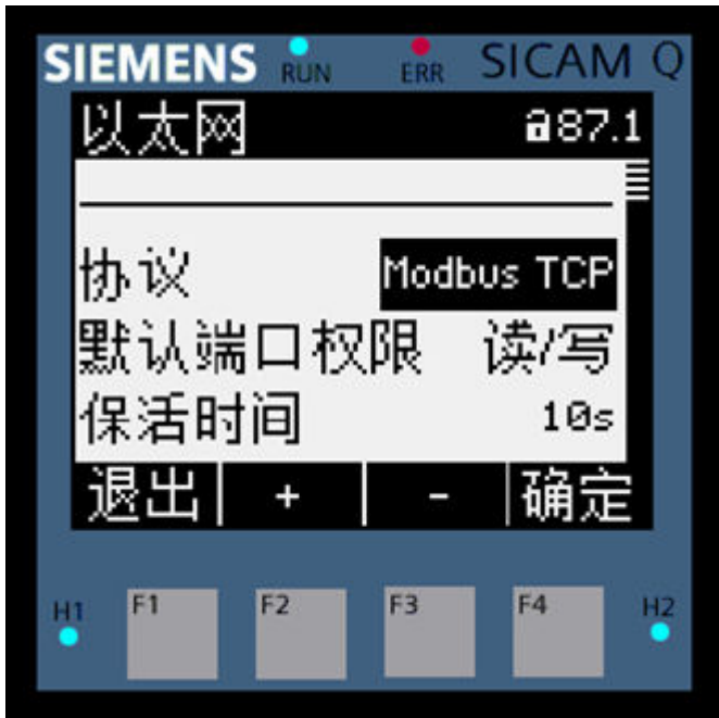
图 3-50 显示屏以太网通信界面-Modbus TCP 协议
