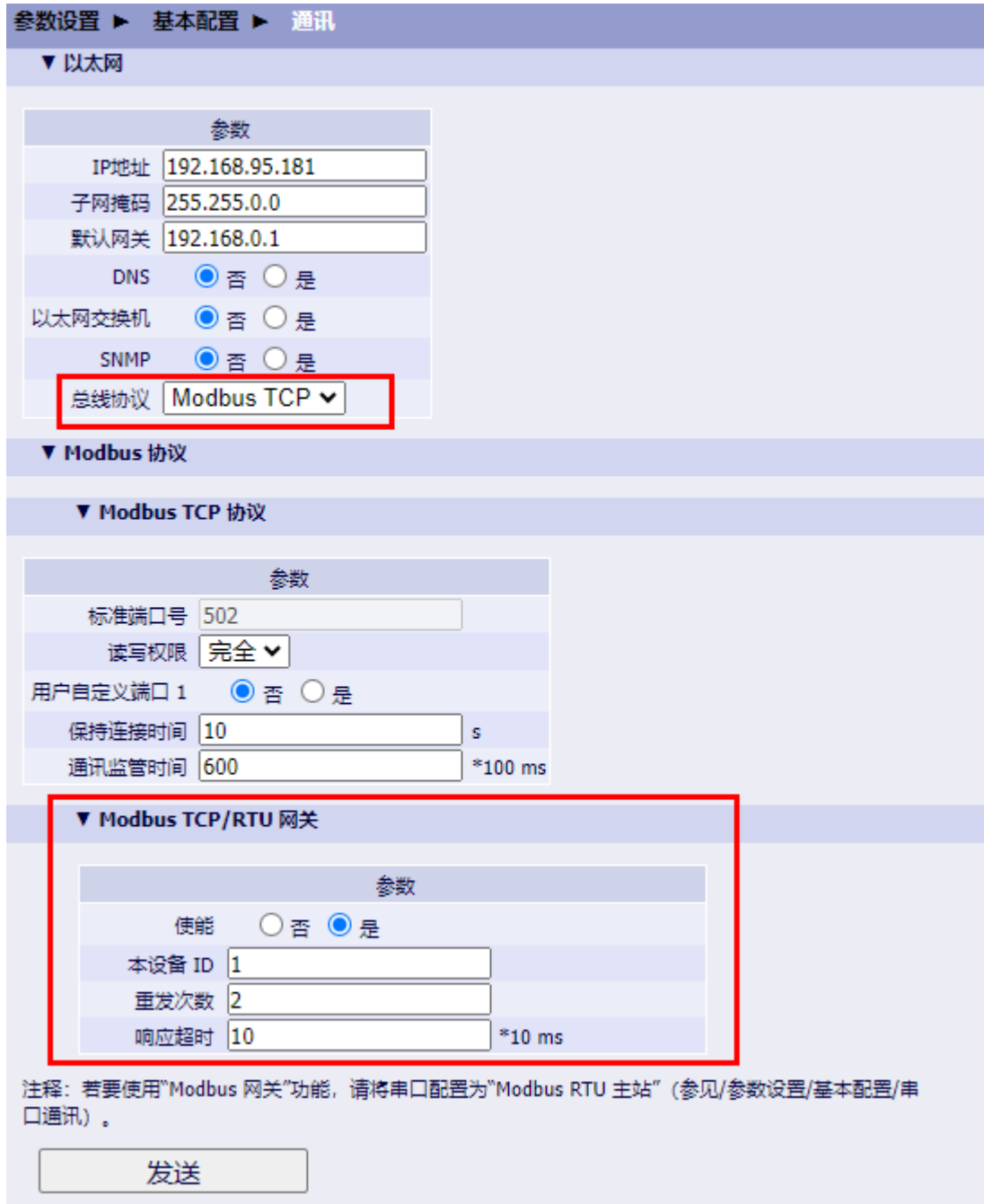
图 3-14 配置 Modbus 网关参数
