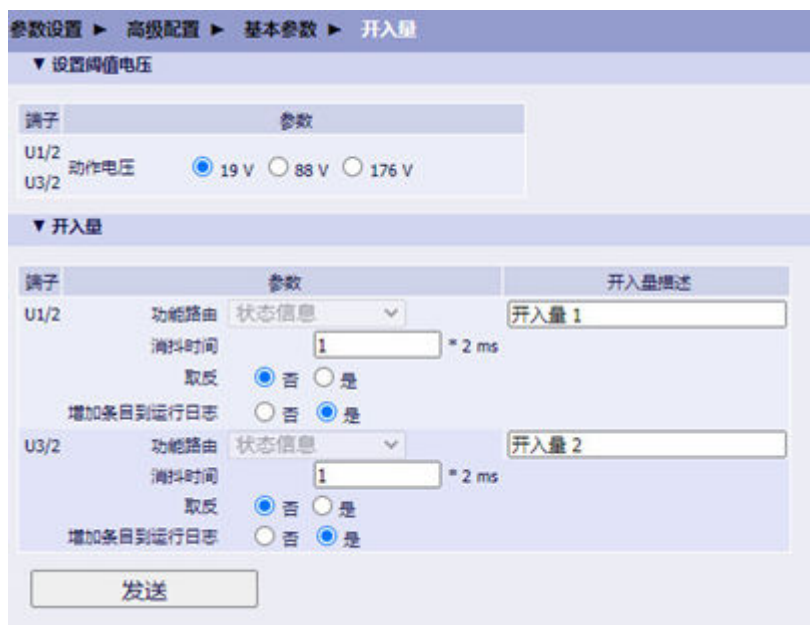
图 5-4 触发电压设置
