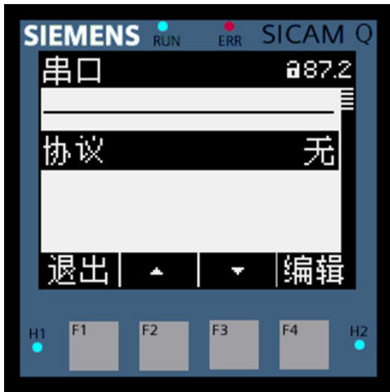
图 3-54 显示屏串口通信界面
