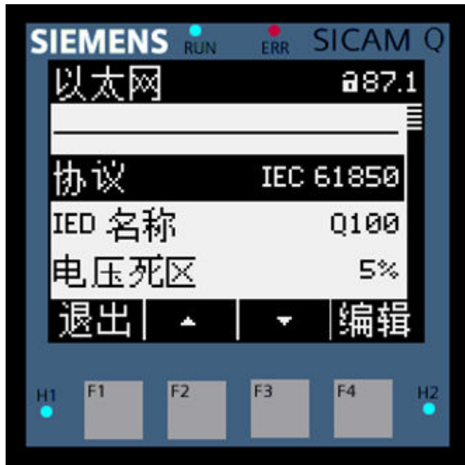
图 3-51 显示屏以太网通信界面-IEC 61850 协议
