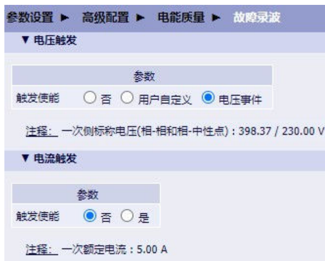
图 5-1 电压、电流触发
