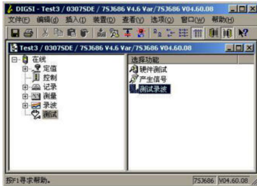
图 3-20 用 DIGSI 触发录波
