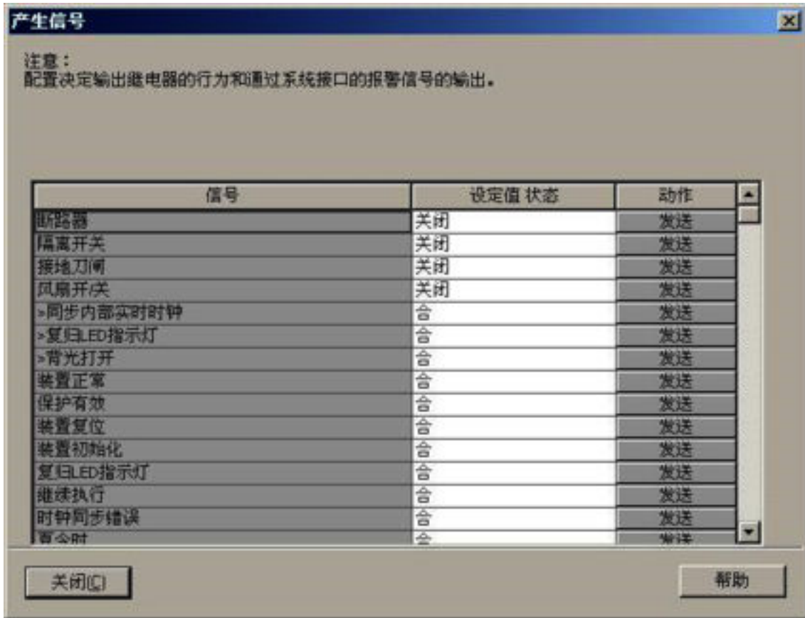
图 3-15 具有对话框的系统接口测试：产生信息- 示例
