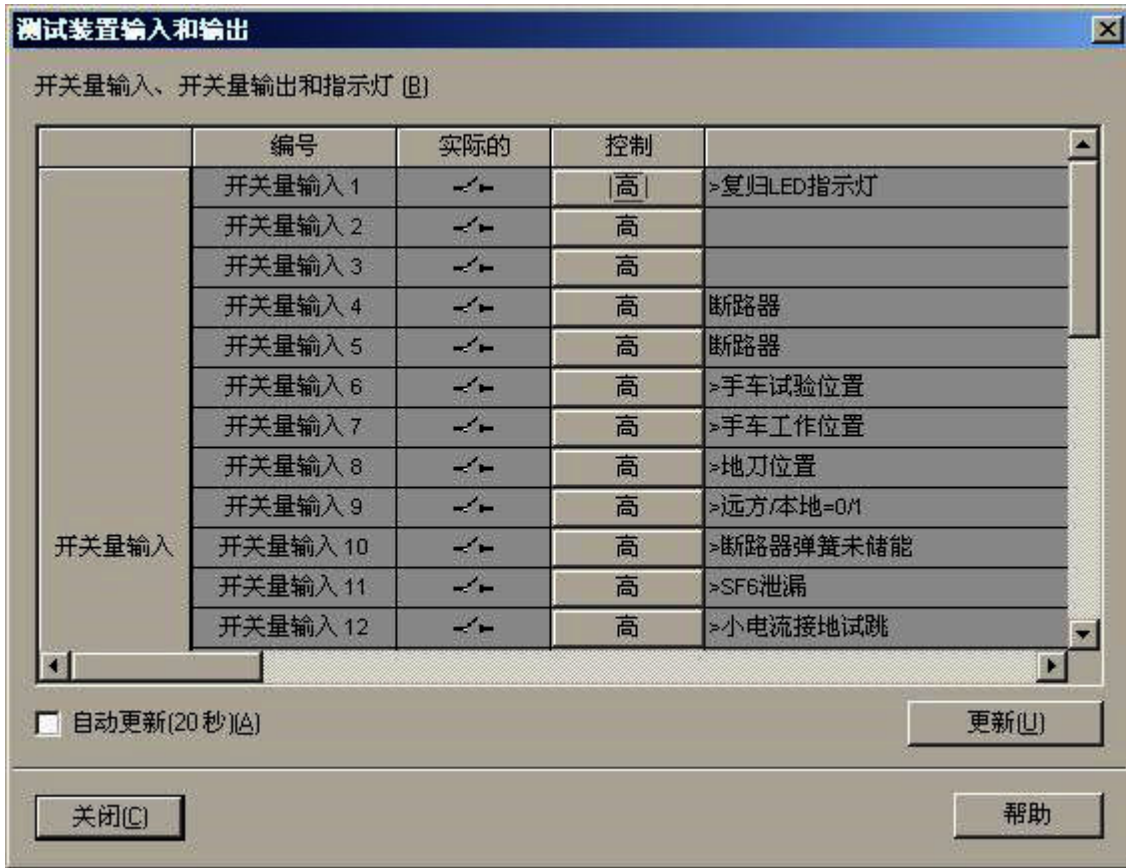
[sc_checking_binary_input_output_eg_1_zh_CN] 图 3-16 测试开关量输入和输出 — 示例
